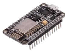
ภาพประกอบ 2 อุปกรณ์ไมโครคอนโทรลเลอร์ NodeMCU ESP8266
